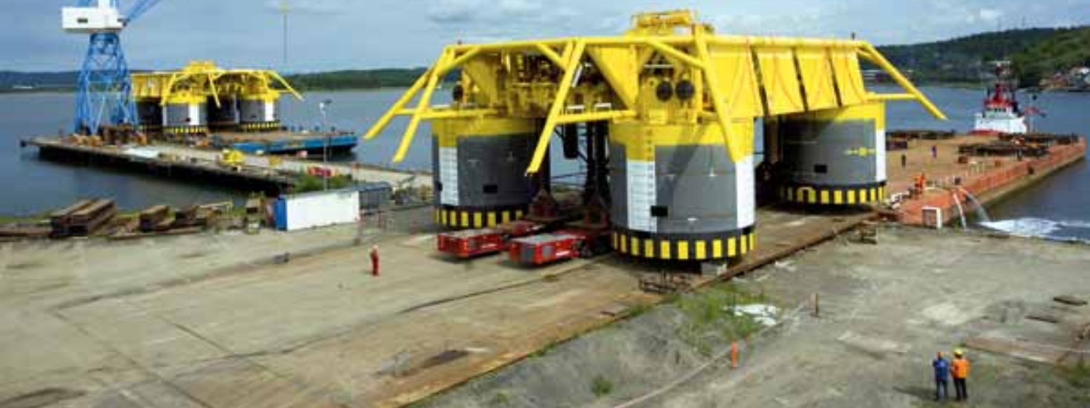
FMC Kongsberg leverte i 2005 to gigantiske produksjonsstasjoner for Ormen Lange-feltet i Norskehavet.
